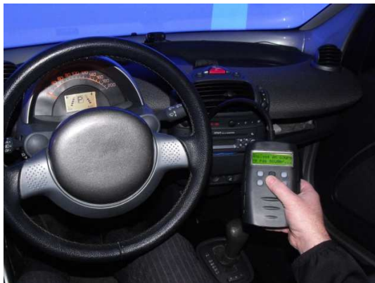
Figure 2. Prototype électronique d'un appareil détectant la consommation d'alcool par spectrométrie tissulaire.
