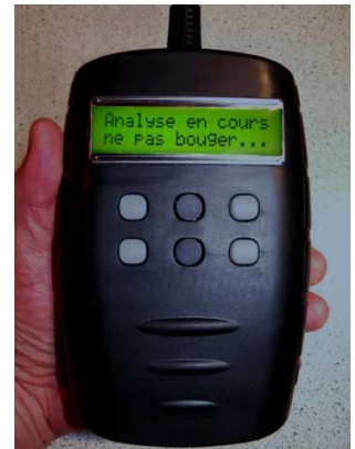
Figure 2. Prototype électronique d'un appareil détectant la consommation d'alcool par spectrométrie tissulaire.
